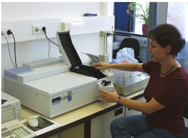
Das ist die Außenansicht eines Photometers. In die geöffnete Klappe wird die Küvette mit der enthaltenen Probe in eine dafür vorgesehene Halterung arretiert, durch die dann das Licht hindurchstrahlt.
