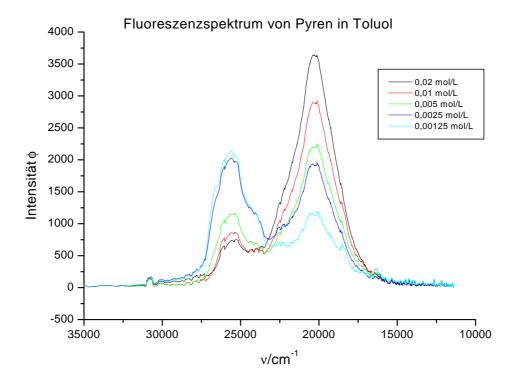
An Hand des Diagramms lassen sich die unterschiedlichen Intensitäten der Monomeren-  $(I_M)$  und Excimerenbanden  $(I_E)$  bestimmen.
