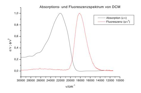
Es ist ein etwa spiegelbildlicher Verlauf der Absorptions- und Fluoreszenzkurve zu erkennen, wobei die Bande der Absorptionskurve jedoch breiter ist. Für die Lage der 00-Übergänge lassen sich die folgenden Werte ermitteln:
